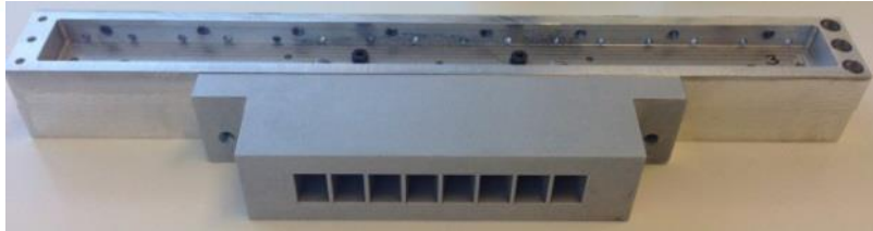
360 GHz antenna array
